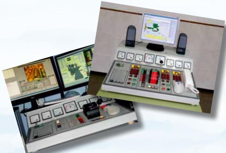
brodu: softver strojarnice sa sporokretnim motorom, strojarnice s jednim te strojarnice s dva srednjekretna motora. Na jednoj hardverskoj konzoli instalirane su dvije vrste strojarnica sa srednjekretnim motorima, a na drugoj dvije strojarnice sa sporokretnim motorima. Novost na ovakvoj vrsti simulatora je trodimenzionalni prikaz i virtualno kretanje učenika po prostorima strojarnice.
