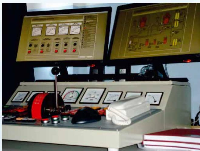
Simulator se sastoji od jednog instruktorskog, šest učeničkih mjesto te dvije hardverske konzole. Na svakom računalu ugrađen je komplet od osam CBT (*Computer Based Training*) modula. Moduli obuhvaćaju sve strojeve i uređaje na konvencionalnom
